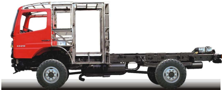
„OP am offenen Fahrerhaus“ Feinste handwerkliche Metallverarbeitung für einen völlig neuen Mannschaftsraum
