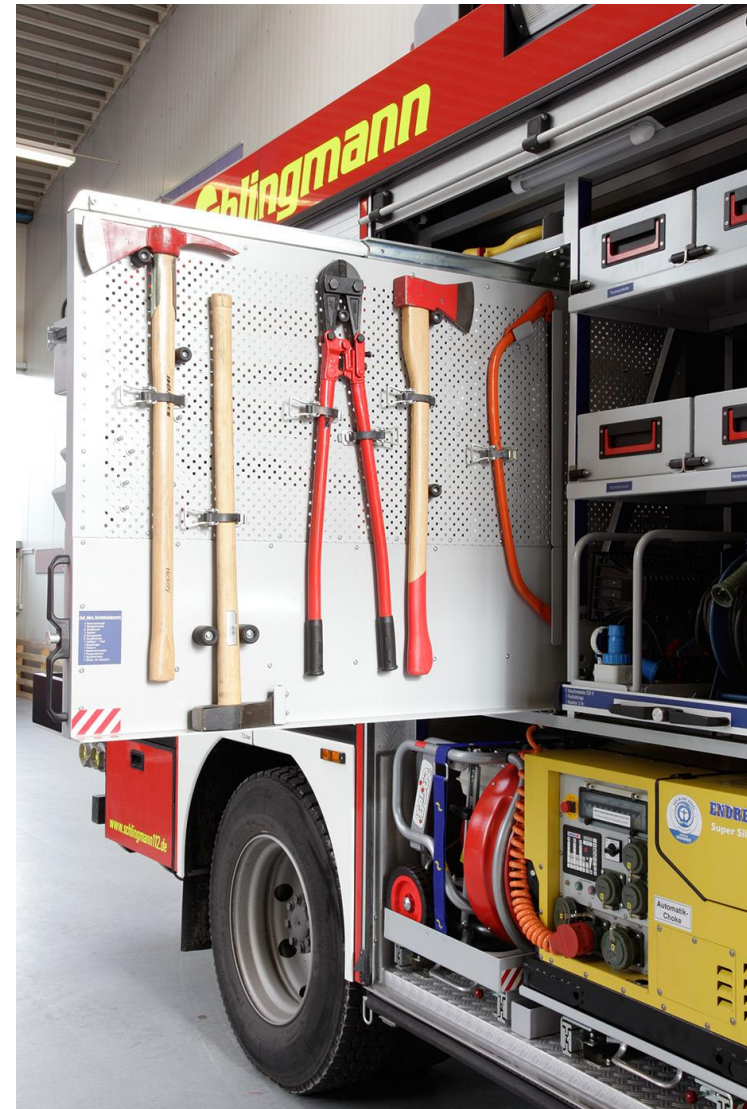
Schneller Zugriff auf alle Gerätschaften, kein Dachkasten notwendig (Absturzgefahr).
