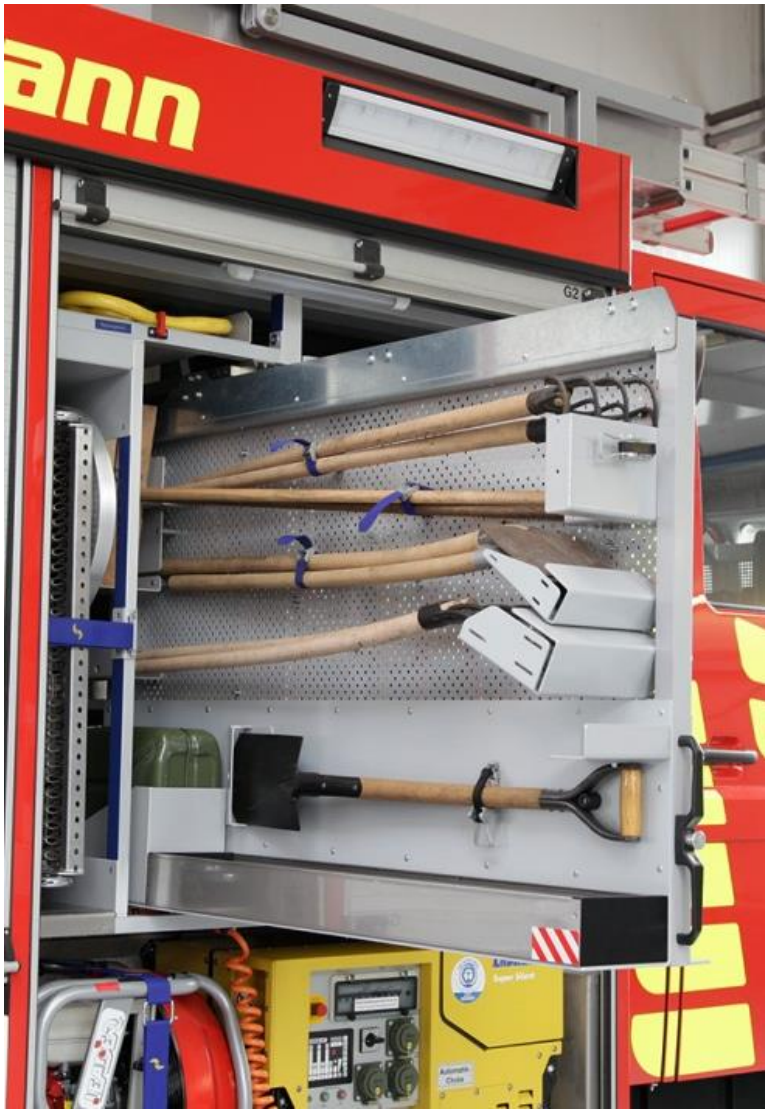
Lagerung der Räumgeräte sowie der Handwerkzeuge gut zugänglich im Geräteraum G1 oder G2 auf einer Schwerlastteleskopausziehwand.
