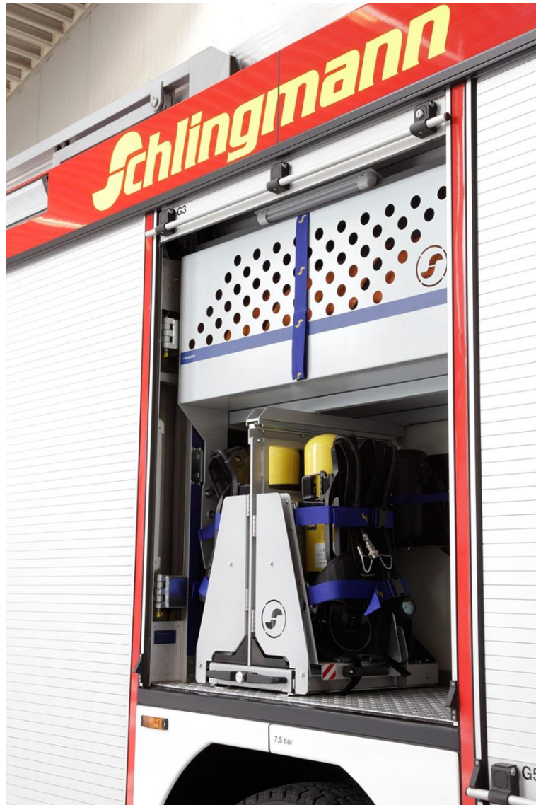
Lagerung des Sprungretter im oberen Bereich von G3.
