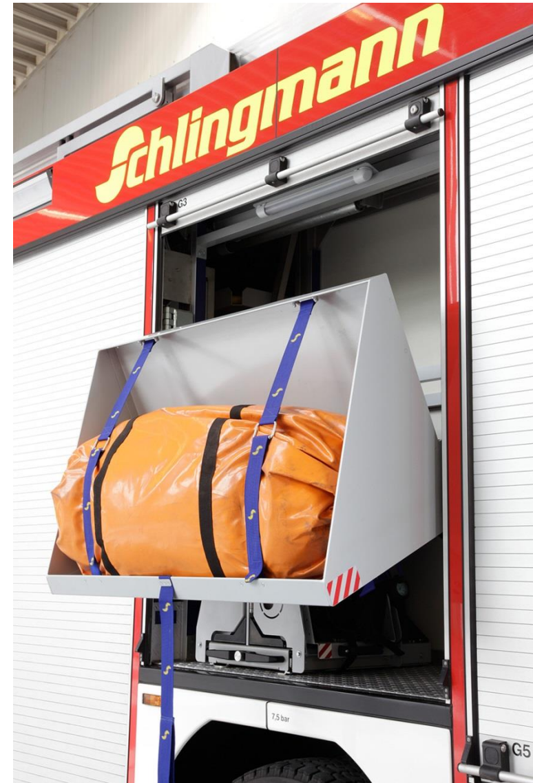
Gasdruckfederunterstützte Absenkung für optimale Entnahmehöhe.
