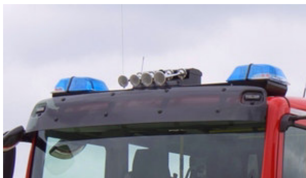
LED-Rundumkennleuchten vorn, Typ ZIRKON/Z2 micro, Fabr. Standby, geteilte Ausführung
