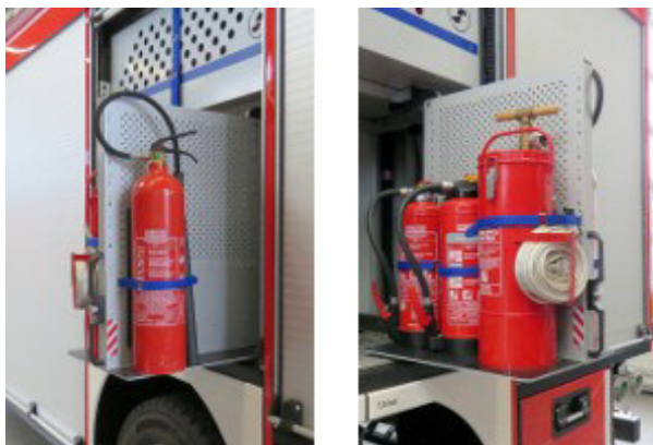
Schiebeelement mit Lochblech, auf stabiler Teleskopschiene gelagert, inklusive Halterungen für z.B. Feuerlöscher, Kübelspritze und weiteres Kleinlöschgerät
