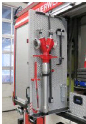
Schiebeelement mit Lochblech, auf stabiler Teleskopschiene gelagert, inklusive Halterungen für z.B. Strahlrohre, Standrohr, Hydrantenschlüssel, Schachthaken etc.
