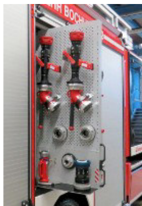
Schiebeelement mit Lochblech, auf stabiler Teleskopschiene gelagert, inklusive Halterungen für z.B. Strahlrohre, Standrohr, Hydrantenschlüssel, Schachthaken etc.
