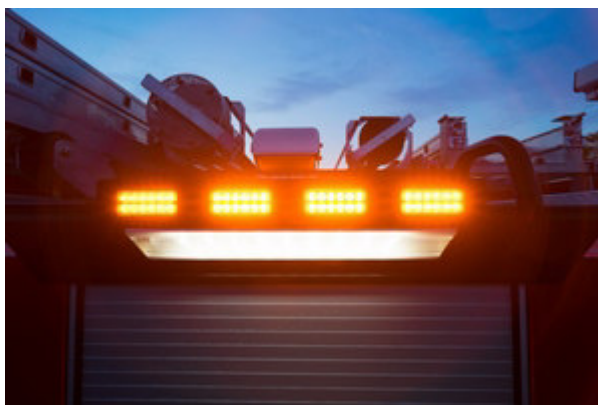
Heckabsicherung in LED-Technik, bestehend aus 4 doppelreihigen gelben Blitzleuchten mit je 12 Hochleistungs-LEDs. Einschalten der Anlage vom Fahrerplatz und am Bedienstand im Aufbau (Wechselschaltung); schaltbar bei langsamer Fahrt. Typ: Axitech MS26AA
