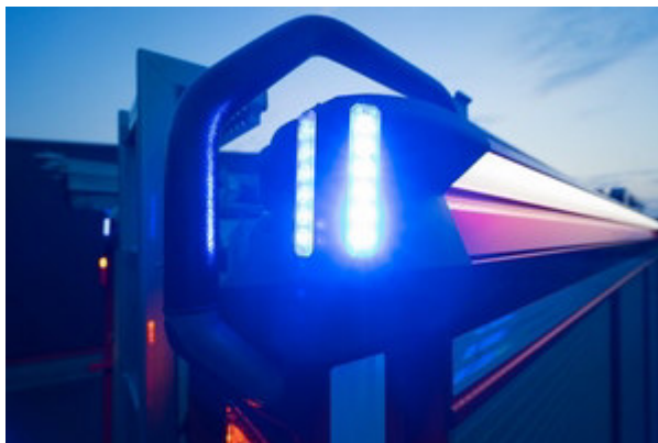
Zwei blaue LED-Blitzelemente am Heck, integriert in die Aufbauecken hinten rechts und links, separat geschaltet
