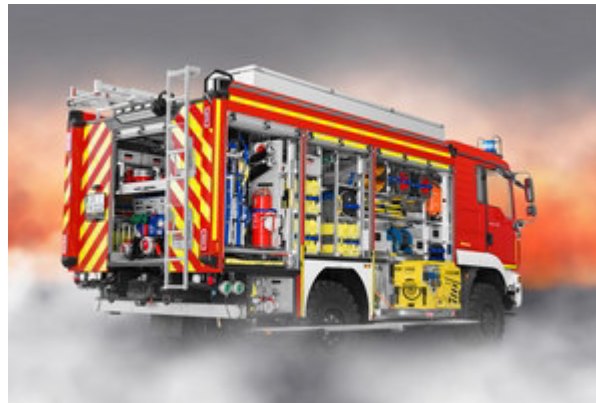
1 Schlingmann VARUS 4x4 Tanklöschfahrzeugaufbau Typ TLF 3000 nach DIN EN 1846 und DIN 14530 Teil 22 passend zum Fahrgestell MAN TGM 13.xxx 4x4 BL, Baureihe TG3, Typennummer 36D, Radstand 3650 mm, Abgasnorm Euro VI, Allradantrieb, Zwillingsbereifung
