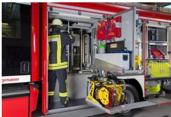
Werkzeugschwenkwand mit Lochblech, Verlagerung der restlichen Halterungen in die 2. Zugriffsebene
