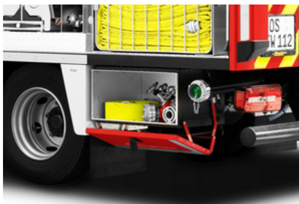
Staukasten auf der linken Fahrzeugseite unterhalb des Aufbaus hinter der Hinterachse. Der Deckel schwingt beim Öffnen automatisch unter das Fahrzeug
