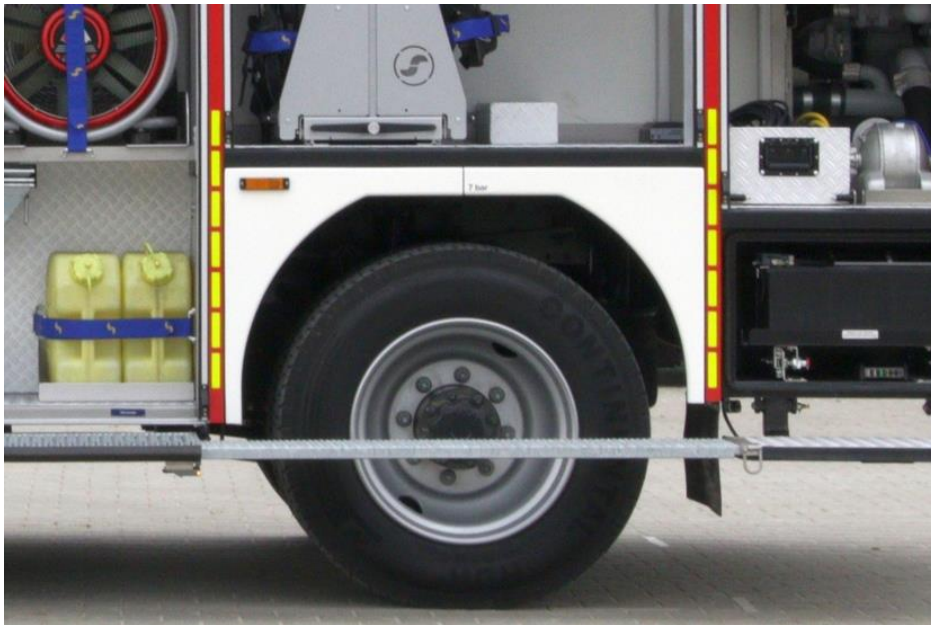
Durchgängige Auftrittsfläche ohne Höhenverlust in den Geräteräumen.
