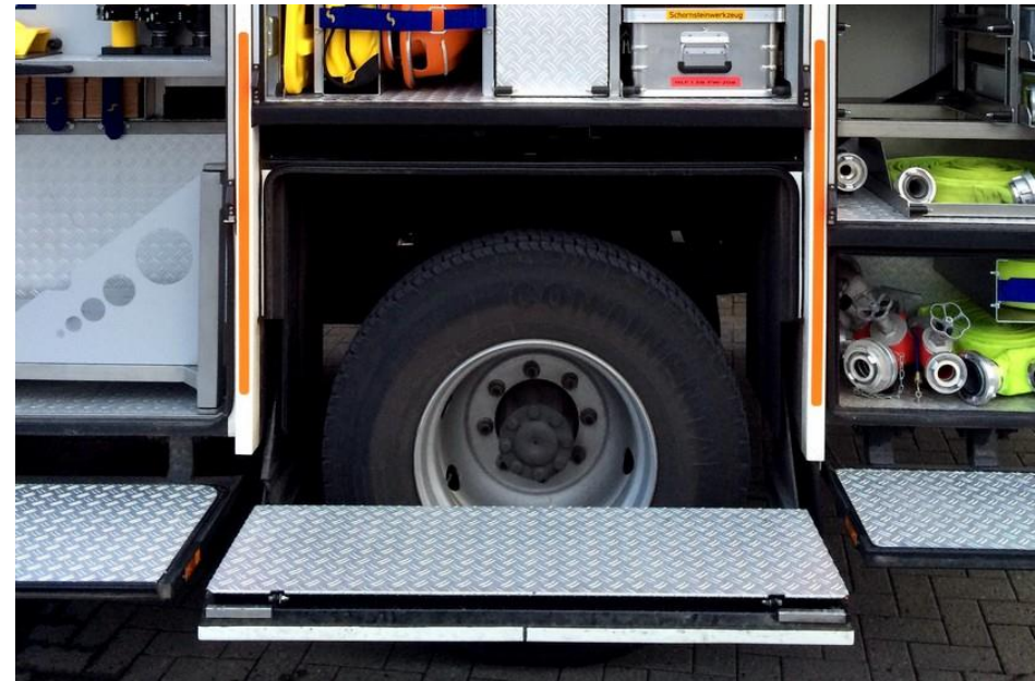
Durch den abklappbaren Kotflügel wandert die Grundfläche der Geräteräume G3 und G4 nach oben, um Platz für den eingeklappten Auftritt zu schaffen. Je nach verwendetem System und Fahrgestell entsteht ein Höhenverlust von bis zu 160 mm.
