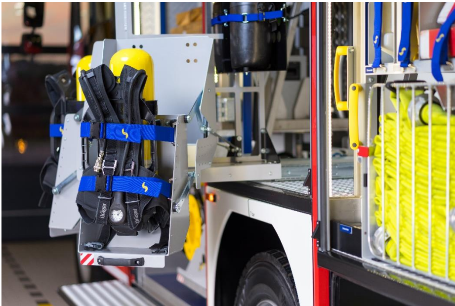
Entnahme der Atemschutzgeräte in ergonomisch günstiger Höhe
