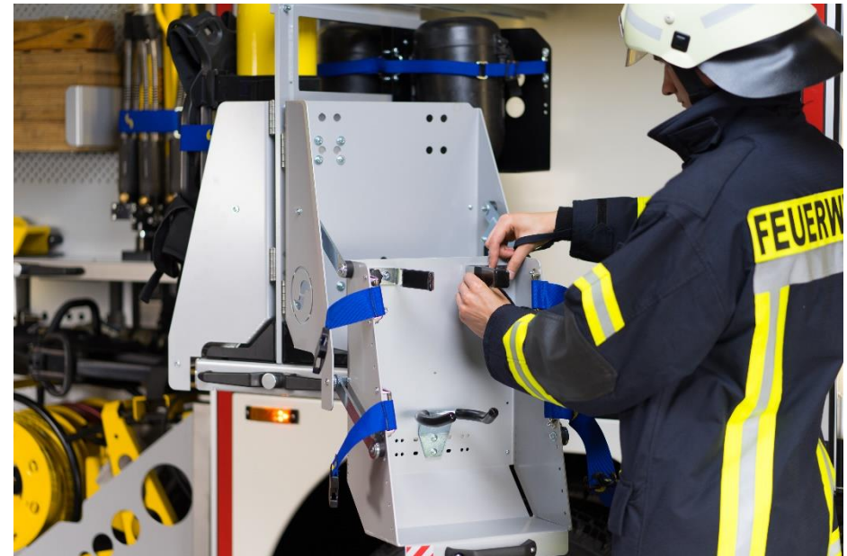
Halterungen lassen sich mithilfe eines Feststellrades auf verschiedene Flaschentypen einstellen
